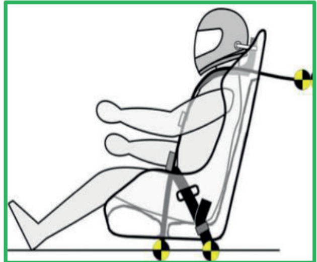
Juiste montage gordels inclusief gat door stoel voor kruisgordel
