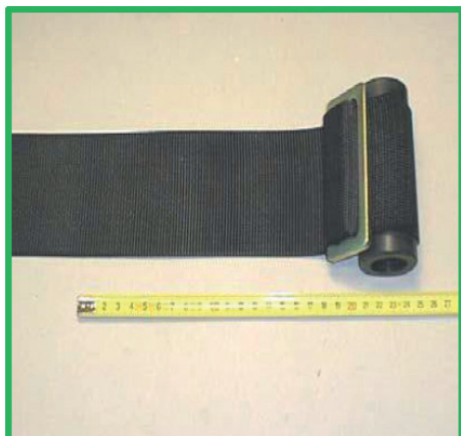
Figuur 2: Correct! De gesp zit tegen gordelbuis, waardoor verschuiven van gesp niet meer mogelijk is
