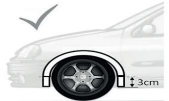
Spatbord verbreding moet minimaal 3cm tot onder de as van het wiel doorlopen
